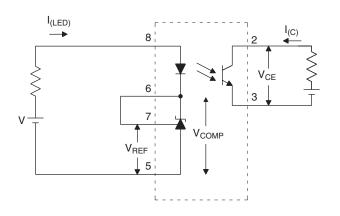
FIG. 6. CTR, V<sub>CE(sat)</sub> TEST CIRCUIT
