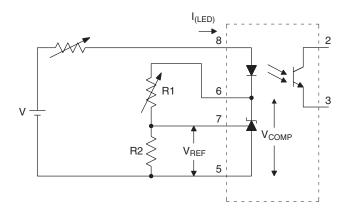
FIG. 2.  $\Delta V_{REF}/\Delta V_{COMP}$  TEST CIRCUIT
