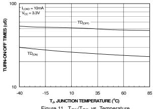
Figure 11.  $T_{ON}/T_{Off}$  vs. Temperature
