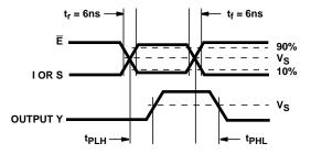
FIGURE 1. PROPAGATION DELAY TIMES
