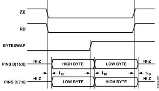
Figure 27. 8-Bit Parallel Interface
