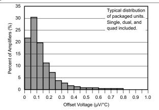
Figure 7. Offset Voltage Production Distribution
