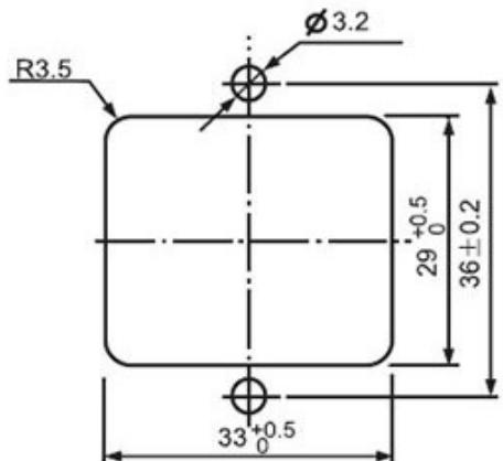
Тип однофазный сетевой фильтр серии DL с сетевым разъемом типа IEC 320 C14
