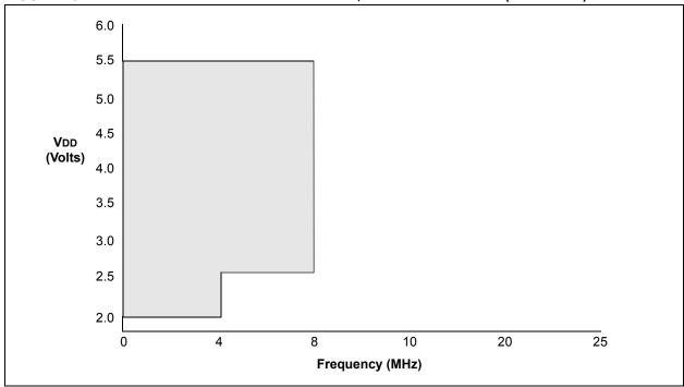
FIGURE 13-2: MAXIMUM OSCILLATOR FREQUENCY TABLE (PIC12F510)
