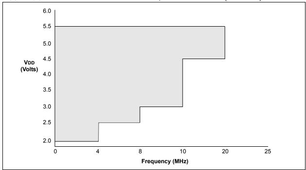
FIGURE 13-4: MAXIMUM OSCILLATOR FREQUENCY TABLE (PIC16F506)
