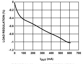
FIGURE 11. V<sub>LOGIC</sub> LOAD REGULATION
