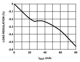
FIGURE 9.  $V_{\mbox{ON}}$  LOAD REGULATION
