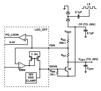
FIGURE 22. V<sub>OFF</sub> FUNCTIONAL BLOCK DIAGRAM
