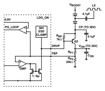
FIGURE 21. VON FUNCTIONAL BLOCK DIAGRAM
