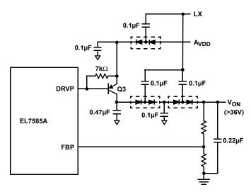
FIGURE 25. THE LINEAR REGULATOR CONTROLS ONE STAGE OF CHARGE PUMP
