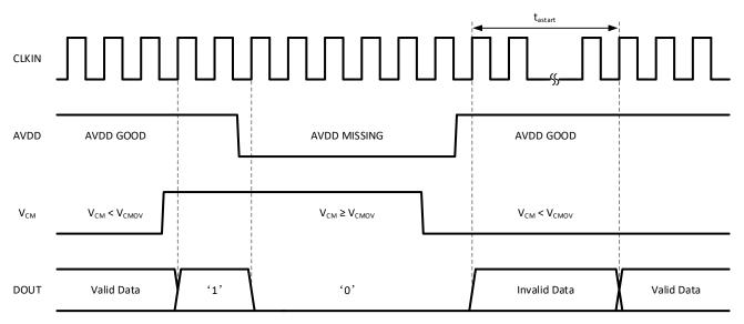
Figure 8-6. CA-IS1305x Fail-Safe Output
