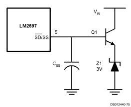
FIGURE 15. External 3.7V Soft-Start Clamp
