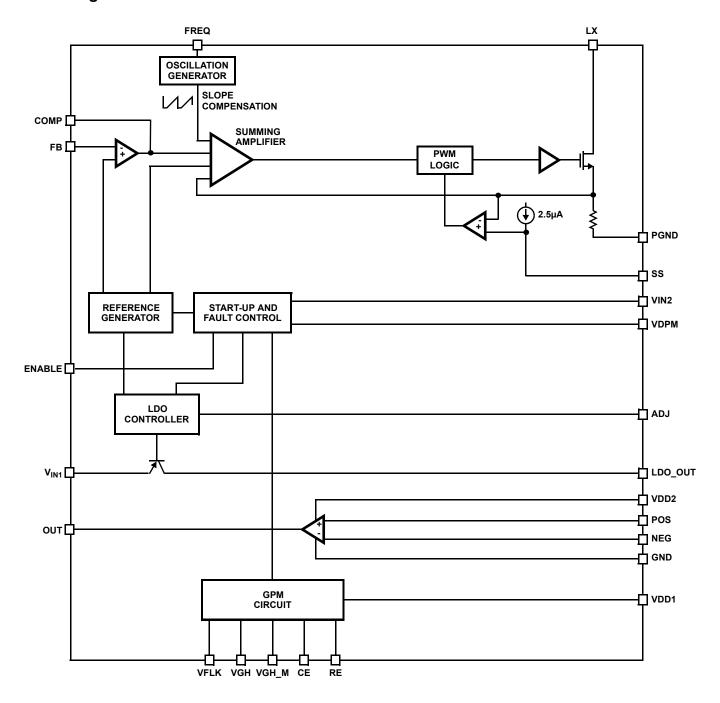
FIGURE 13. ISL97646 BLOCK DIAGRAM
