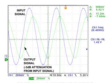
FIGURE 12. V<sub>COM</sub> BANDWIDTH MEASUREMENT
