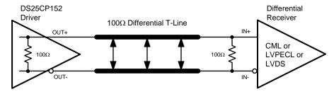
Figure 11. Typical DS25CP152 Output DC-Coupled Interface to an LVDS, CML or LVPECL Receiver
