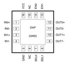
Figure 3. DS25CP152 Pin Diagram
