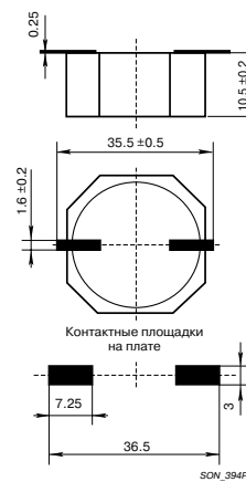
SMAT-30, конструкция для поверхностного монтажа
