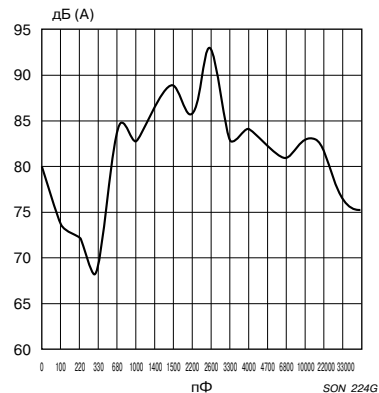
SMB-57CC, зависимость звукового давления от величины подключенной емкости
