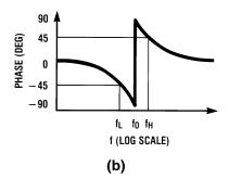
$$\label{eq:hamma_norm} \textbf{H}_{\textbf{N}}(\textbf{s}) = \frac{\textbf{H}_{\textbf{ON}}(\textbf{s}^2 + \omega_{\textbf{O}}^2)}{\textbf{s}^2 + \frac{\textbf{s}\omega_{\textbf{O}}}{\textbf{Q}} + \omega_{\textbf{O}}^2}$$
