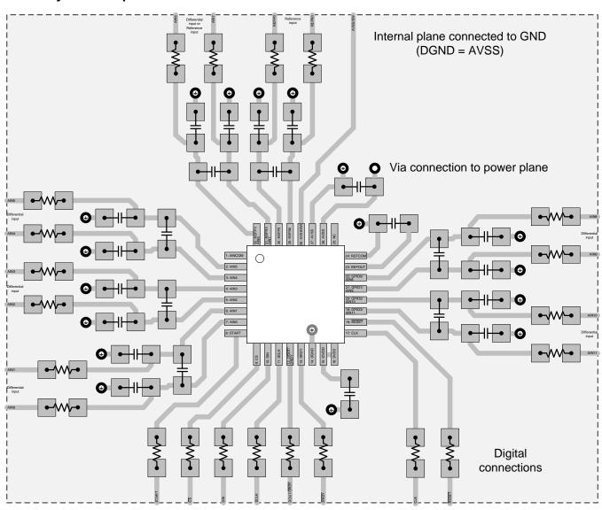
Figure 121. ADS114S0x Layout Example
