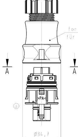
for cable diameter 6-10mm für Kabeldurchmesser 6-10mm
