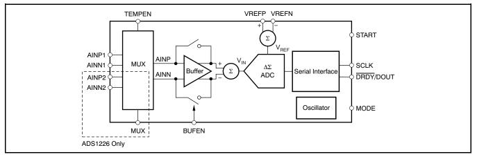
Figure 19. Conceptual Diagram of the ADS1225 and ADS1226
