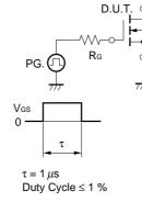
**TEST CIRCUIT 2 SWITCHING TIME**
