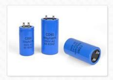
Конденсаторы CD60 — металлизированные электролитические пленочные конденсаторы постоянной ёмкости в герметизированном цилиндрическом корпусе, накапливают заряд от 50мкФ до 1500мкФ при рабочем напряжении переменного тока от 220В до 450В. Конденсатор CD60 может применяться как пусковой или рабочий. Предельное допустимое отклонение ёмкости ±5%, ±10%, ±20%.
