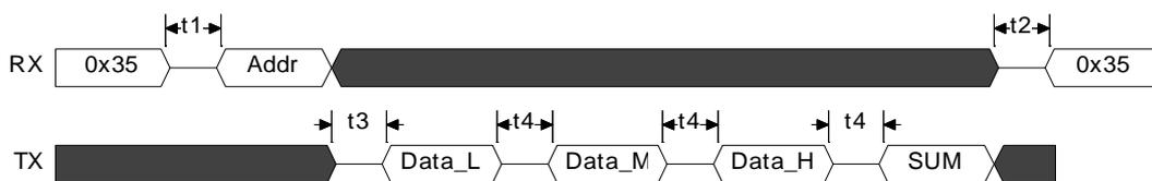
主机 UART 读数据时序如下图所示，主机先发送命令字节(0x35)，然后发送需要读取的地址字节 (ADDR)，接下来 BL0910 依次发送数据字节，最后校验和字节。
