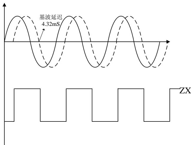
注意:为防止底噪信号或小信号存在的杂散信号带来的不确定性,电流过零阈值为 70000,电压过零阈值为 200000.如果瞬时有有效值比阈值小,无 ZX 信号。
