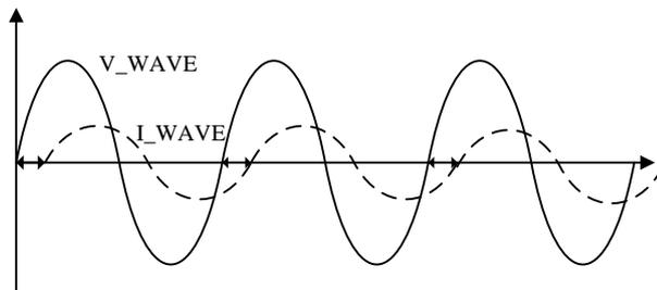
通过计算电流和电压的正向过零之间的时间差得到相位差，对应时间值更新到寄存器 ANGLE[N]，每个寄存器是 16 位无符号数。
