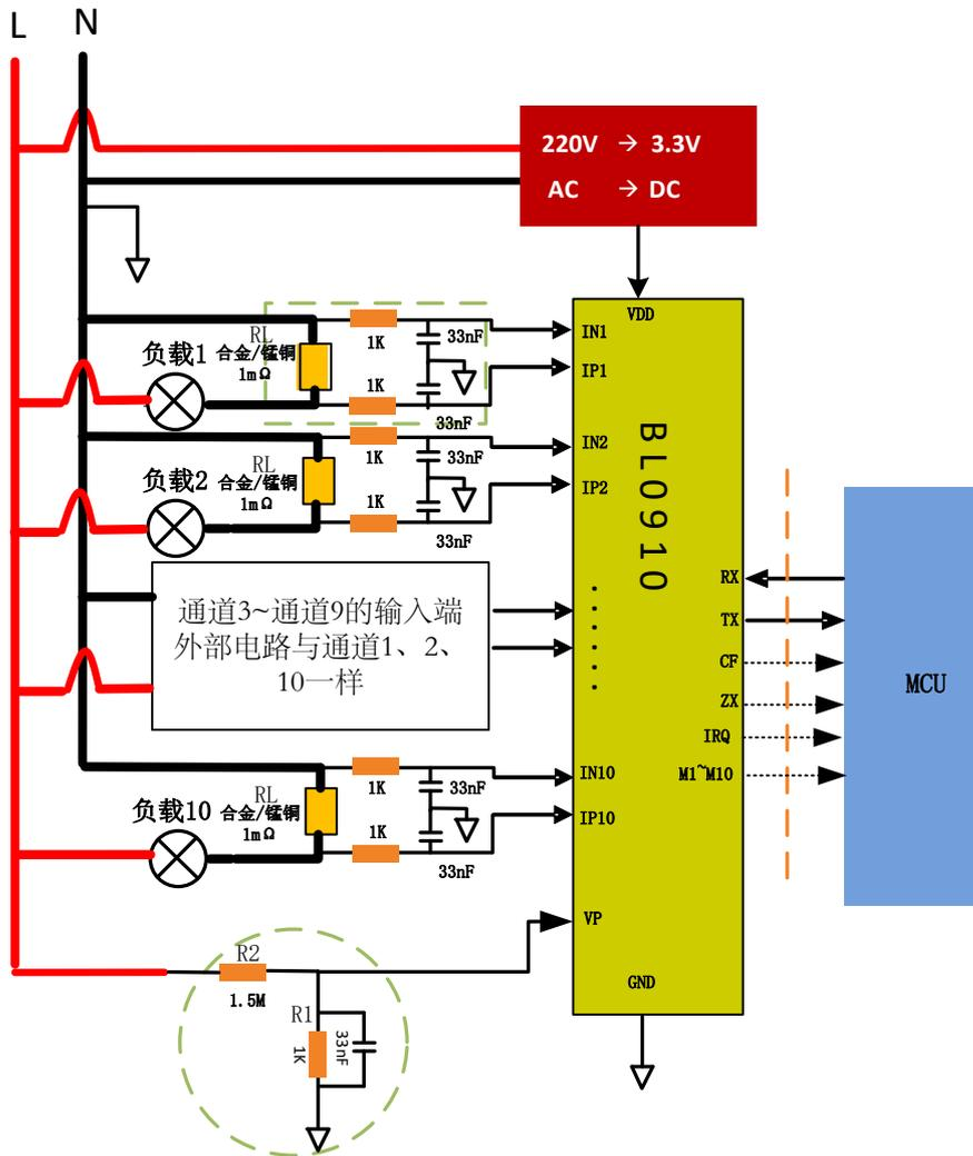
对于1U10I应用，每个电流通道外部线路图都一样，电压通道需要信号分压。
