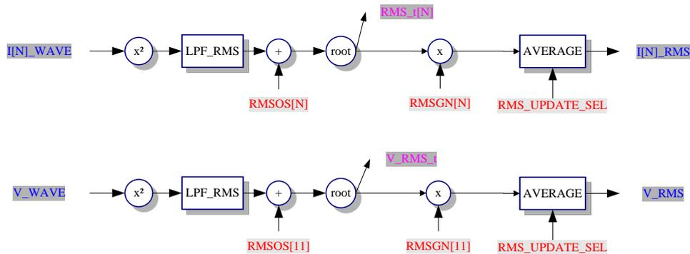
每个通道的原始波形,经过平方电路( $X^2$ )、有效值低通滤波器(LPF\_RMS)、开根电路 (ROOT), 得到有效值的瞬时值  $RMS_t$ , 再经过平均得到每个通道的平均值  $I[N]_{RMS}$  和  $V_{RMS}$ 。
