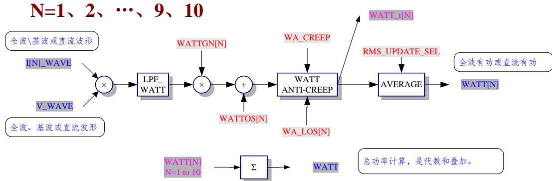
电流和电压波形通过数字乘法，然后依顺序经过低通滤波器、增益和偏差校准、防潜动判断及平均处理后可以获得功率信号。
