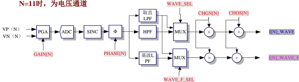
共有 11 路相同结构的高精度的 ADC，采用双端差分信号输入：第 N 路电流通道输入的正负电压信号为 VP[N]和 VN[N]。
