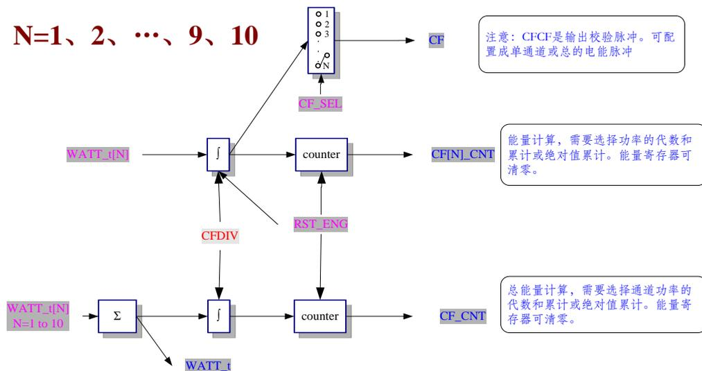
提供 10 通道的电能脉冲累计。原理是每个通道的有功功率通过一段时间的积分，可获得这段时间有功能量，并进一步把能量转化成对应频率校验脉冲 CF，
