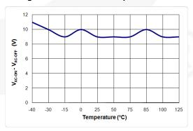
Figure 11. V<sub>AC-ON</sub> – V<sub>AC-OFF</sub> vs. Temperature
