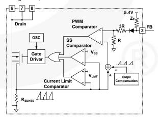
Figure 20. Soft-Start and Current-Limit Circuit
