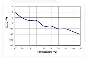
Figure 10. V<sub>AC-ON</sub> vs. Temperature
