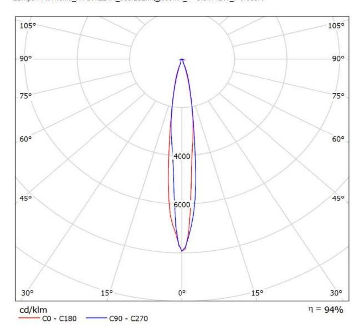
Luminaire: Ledil Oy CS14895\_HB-IP-2X6-RS\_(Duris\_P8)\_SIMULATED
