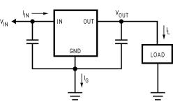
Figure 28. Power Dissipation Diagram
