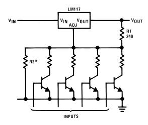
\*Sets maximum  $V_{\text{OUT}}$
