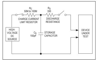
Figure 9a. IEC 61000-4-2 ESD Test Model
