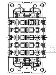
mit Federkraftanschluß with spring connection
