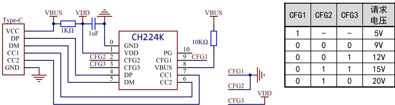
6.3. CH224K 使用 Type-C 公口，仅使用 PD 协议和 E-Mark 模拟功能 (图中电阻配置 NC 为 20v)
