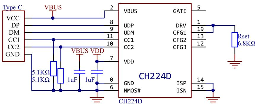
6.2. CH224K 使用 Type-C 母口，电平配置 5/9/12/15/20V (图中电平方式配置为 12v)
