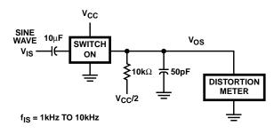
FIGURE 5. SINE WAVE DISTORTION TEST CIRCUIT
