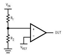
Figure 20. Threshold Detector
