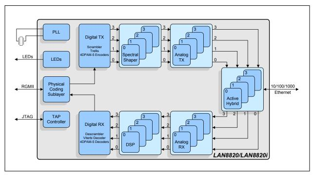
FIGURE 1-2: SYSTEM LEVEL BLOCK DIAGRAM
