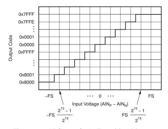
Figure 39. ADS1118 Code Transition Diagram
