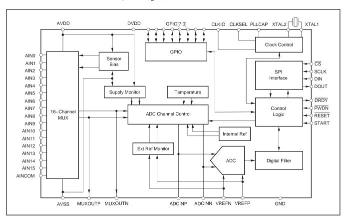
Figure 33. ADS1258 Block Diagram
