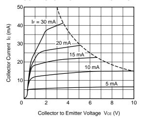
COLLECTOR CURRENT vs. COLLECTOR SATURATION VOLTAGE
