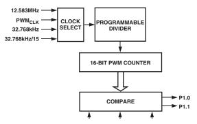
Figure 26. PWM Block Diagram
