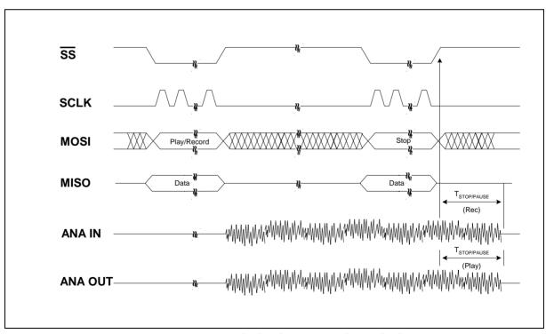
FIGURE 8: PLAYBACK/RECORD AND STOP CYCLE
