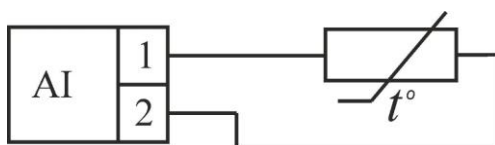
Рисунок 5 Подключение к модулю термопреобразователей сопротивления
