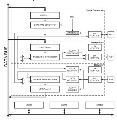
Figure 20-1. USART Block Diagram<sup>(1)</sup>
