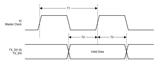
Figure 6-6. RMII Transmit Timing
