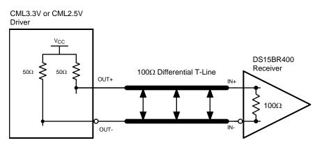
Figure 12. Typical CML Driver DC-Coupled Interface to DS15BR400 Input
