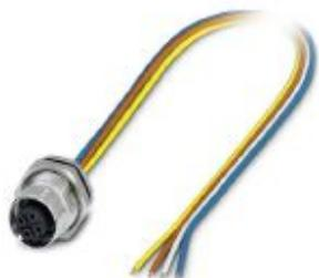
Встраиваемая розетка шинной системы, PROFINET, 4-полюсная, M12-SPEEDCON, с механическим ключом D-типа, монтаж с задней части стенки / резьбовое крепление Pg9, с гибким проводом 0,5 м (изоляция из TPE), 4 x 0,34 мм<sup>2</sup>
