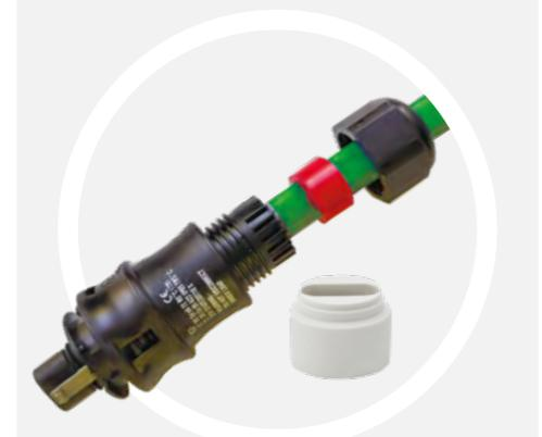
Разъемы серии **gesis®RST** поставляются с предустановленными уплотнителями для кабелей круглого сечения. Для адаптирования разъема к установке на профилированный греющий кабель требуется удалить штатный уплотнитель и на его место установить специализированный, приобретаемый отдельно (инструкция на стр. 32).
