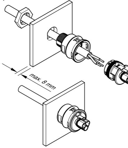
Установка разъема в панель с проходными отверстиями M16, M20.
