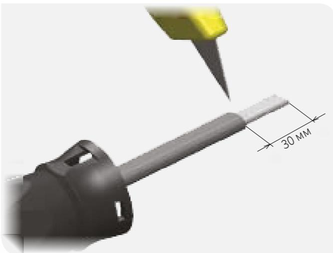
1. Ослабьте и открутите гайку кабельного ввода. 2. При помощи монтажного инструмента снимите В случае установки на кабель плоского профиля внешний изоляционный слой греющего кабеля. замените штатный сальниковый уплотнитель на специализированный. (см стр. 32)
