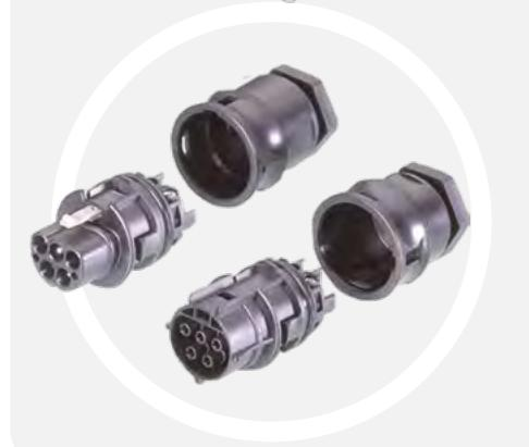
**Односекционные** (неразборные), устанавливаются в отверстие в панели корпуса диаметром 25,4 мм (M25). Пространственно основная часть разъема располагается внутри корпуса, снаружи корпуса располагается только лицевая сторона контактной группы разъема. Фиксация односекционного разъема M25 в панели корпуса обеспечивается удерживающей гайкой, устанавливаемой с наружной стороны корпуса.
