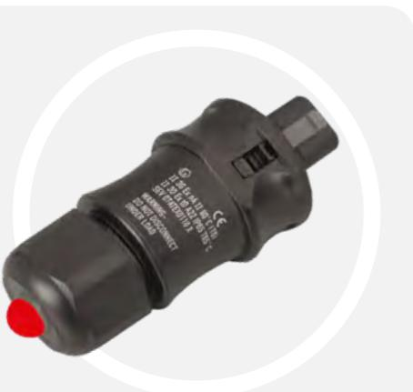
В качестве **индикаторного элемента** используется вилочный разъем со встроенным индикатором (220VAC). Компактный конструктив позволяет применять его в качестве опционального элемента в составе ответвительных и разветвительных узлов, возможна установка индикатора на конец кабельной секции вместо заглушки. Освоен выпуск прямого исполнения индикатора со светоизлучающим элементом красного цвета, предполагается выпуск углового исполнения и с СИД различных цветов.
