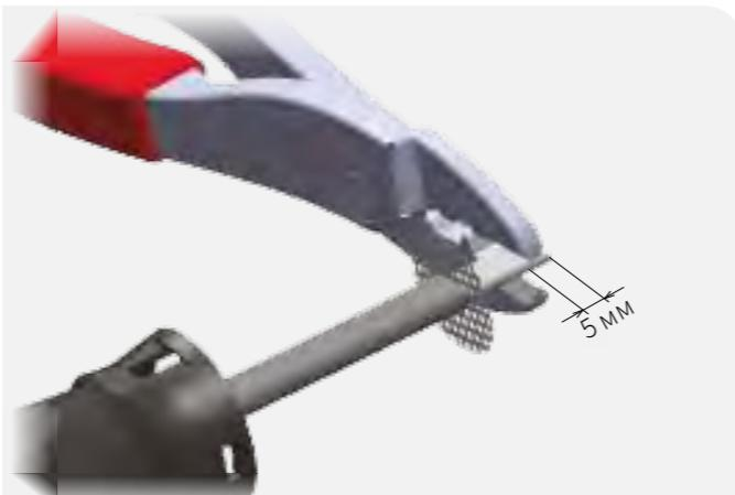
3. “Распушите” экранирующую оплетку, оголив слой внутренней изоляции.
