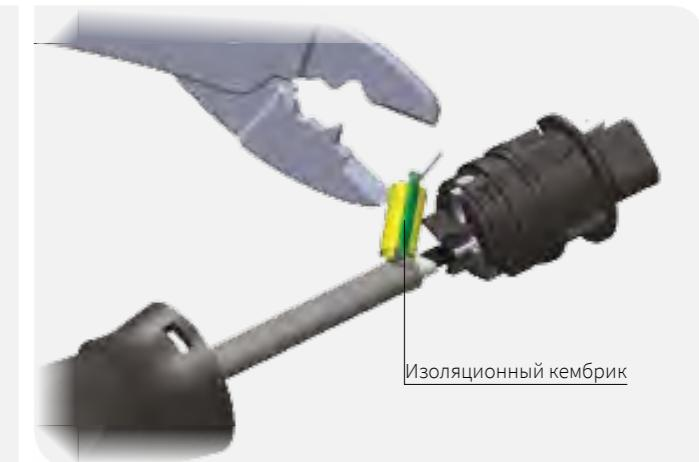
9. Скрутите экранирующую оплетку до образования однородной нити. Убедитесь, что скрученная оплетка находится на стороне гнезда заземления контактной вставки. Убедитесь, что длина оплетки достаточна для ввода в зажимную клетку заземляющего гнезда контактной вставки.
