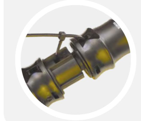
По умолчанию разъемы поставляются с предустановленным на розеточную часть фиксатором соединения. Фиксатор является легкогнездным и легкозаменяемым. В случае, если требуется легкоразъемное соединение, фиксатор удаляется из состава разъемной пары.
