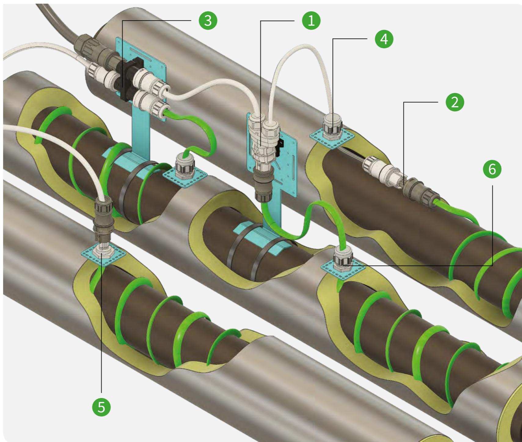
**Подключение нагревательной секции под слоем теплоизоляции** при помощи монтажной пластины и кабельввода для силового кабеля.
