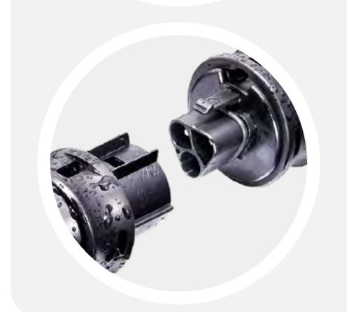
Для соединения двух разъемов вдвиньте их друг в друга до щелчка. Для рассоединения разъемной пары требуется отверткой DIN 5264 A 0,6 x 3,5 нажать на выступающую видимую часть фиксатора и повернуть отвертку на 90°. Разъемы освободятся от замкового соединения.
