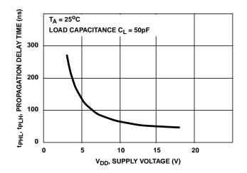
FIGURE 9. TYPICAL PROPAGATION DELAY TIME AS A FUNCTION OF SUPPLY VOLTAGE
