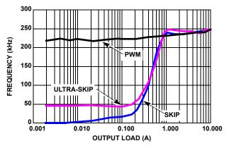
FIGURE 21. V<sub>OUT2</sub> = 1.05V FREQUENCY vs LOAD
