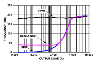
FIGURE 23. V<sub>OUT1</sub> = 1.5V FREQUENCY vs LOAD
