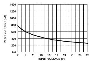
FIGURE 32. SKIP NO LOAD INPUT CURRENT vs V<sub>IN</sub>
