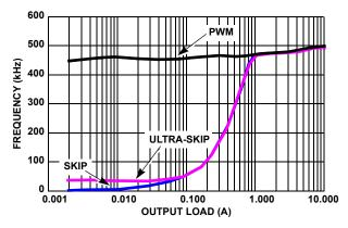
FIGURE 25. V<sub>OUT2</sub> = 3.3V FREQUENCY vs LOAD
