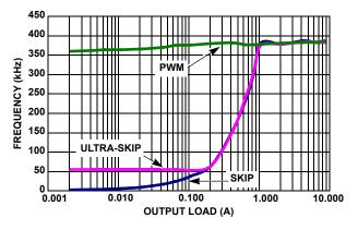
FIGURE 27. V<sub>OUT1</sub> = 5V FREQUENCY vs LOAD
