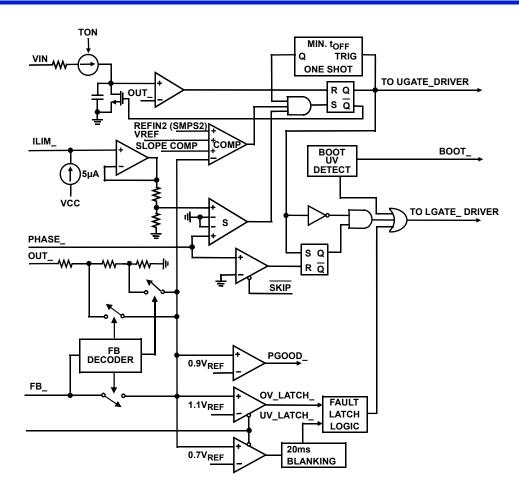
FIGURE 66. PWM CONTROLLER (ONE SIDE ONLY)
