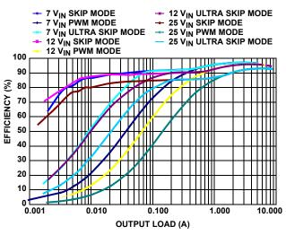
FIGURE 4. VOUT1 = 5V EFFICIENCY vs LOAD (400kHz)
