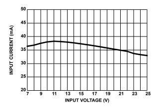
FIGURE 31. PWM NO LOAD INPUT CURRENT vs V<sub>IN</sub>
