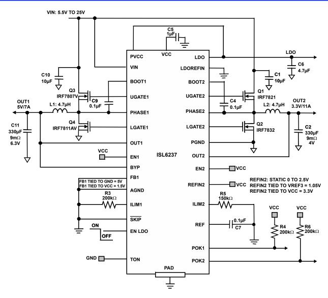
FIGURE 64. ISL6237 TYPICAL 3.3V/5V SYSTEM REGULATOR APPLICATION CIRCUIT
