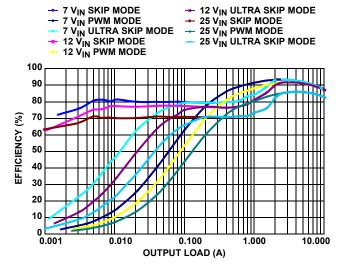
FIGURE 1. V<sub>OUT2</sub> = 1.05V EFFICIENCY vs LOAD (300kHz)
