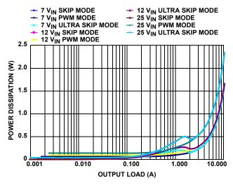
FIGURE 9. V<sub>OUT2</sub> = 1.05V POWER DISSIPATION vs LOAD (300kHz)
