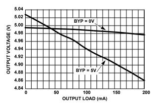
FIGURE 29. LDO OUTPUT 5V vs LOAD
