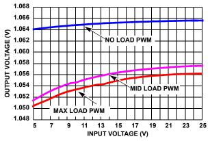
FIGURE 14. V<sub>OUT2</sub> = 1.05V OUTPUT VOLTAGE REGULATION vs V<sub>IN</sub> (SKIP MODE)
