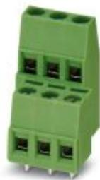
Клеммы для печатной платы, номинальный ток: 17,5 А, расчетное напряжение (III/2): 400 В, номинальное сечение: 1,5 мм<sup>2</sup>, размер шага: 5 мм, полюсов: 3, тип подключения: Винтовой зажим с натяжной гильзой, монтаж: Пайка волной припоя, направление подключения, проводник/печатная плата: 0 °, цвет: зеленый, Расположение контактов: Линейное расположение выводов, Длина выводов [P]: 3,5 мм. Возможна установка в ряд модулей с различным количеством полюсов (контактов)!
