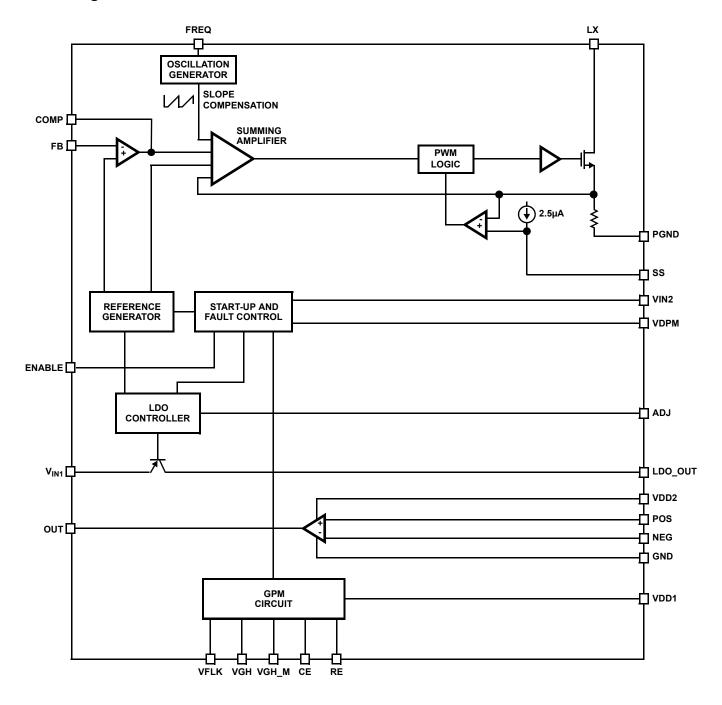
FIGURE 13. ISL97644 BLOCK DIAGRAM
