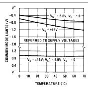
Figure 23. Common-Mode Limits
