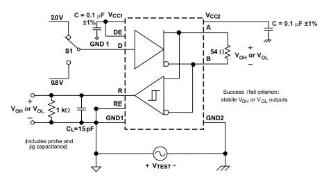
Figure 27. Common-Mode Transient Immunity Test Circuit
