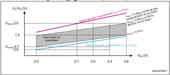
Figure 19. V<sub>IH</sub>/V<sub>IL</sub> versus VDD (TTL I/Os)
