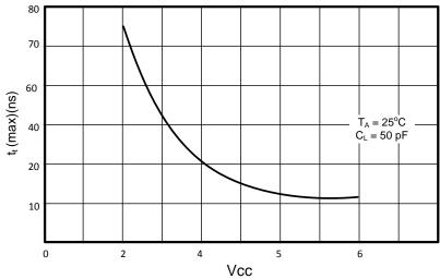
Figure 1. t<sub>t</sub> vs V<sub>CC</sub>
