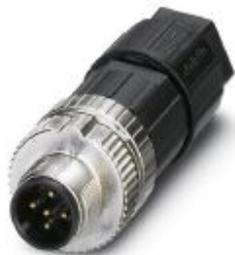
Разъем, Универсальный, 5-полюсн., неэкранированный, Штекеры прямое M12, Кодирование: A, Зажимы Push-in, материал накатанной гайки: Цинк. литья под давлением, с никелевым покрытием, наружный диаметр кабеля 4 мм ... 8 мм
