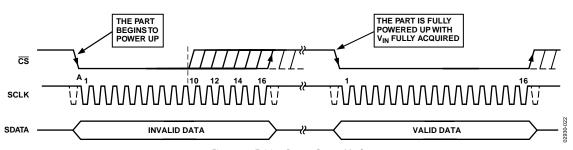
Figure 22. Exiting Power-Down Mode
